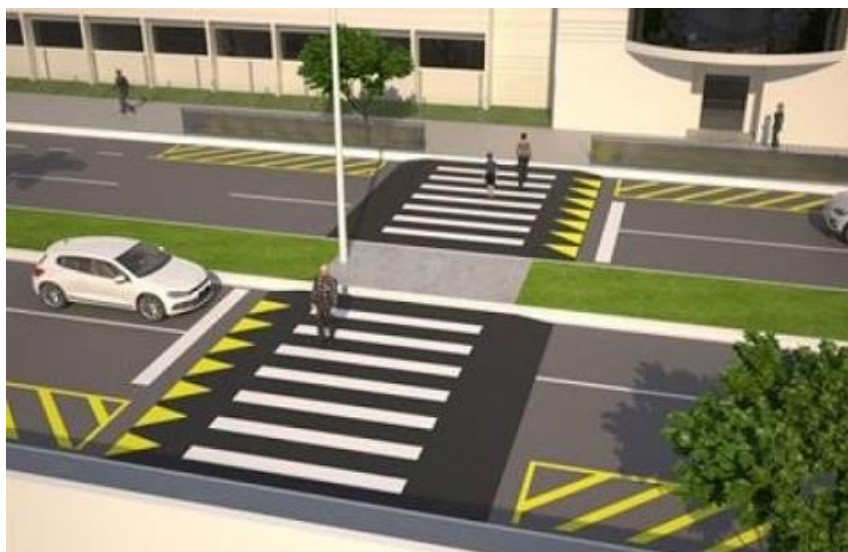
Figura 9.2 - Desenho ilustrativo de travessias elevadas
